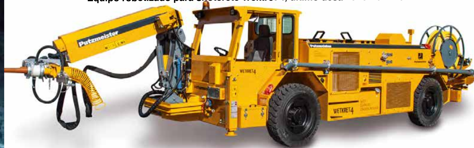
Equipo robotizado para shotcrete Wetzket 4, último desarrollo Putzmeister
